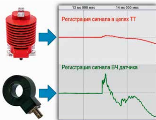
Рис. 4. Эффект применения высокочастотных датчиков частичных разрядов для регистрации аварийной волны
